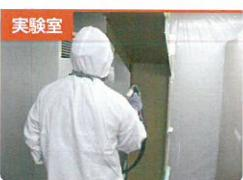
寒冷・温暖地の条件下で発泡の状態、接着度の変化を環境実験室で再現し施工検証を行っています。
