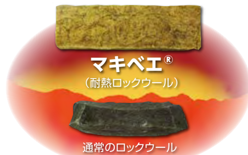
マキベエと通常のロックウールを800℃の中に放置した時の収縮比較。
